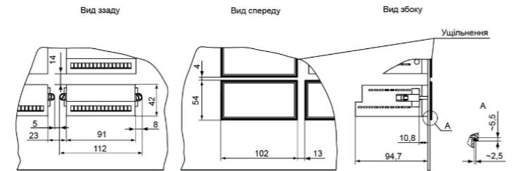
Рисунок 2 – Пристрій у корпусі Щ2, встановлений у щит завтовшки 3 мм
