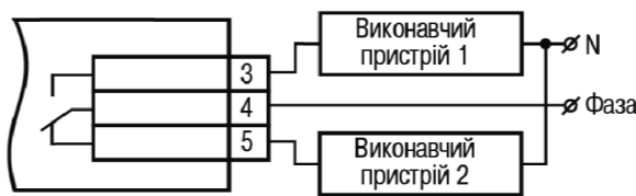
Рисунок 10 – Схема підключення навантаження до ВП типу Р
