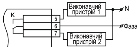
Рисунок 5.5 – Схеми підключення навантаження до ВП типу Р
