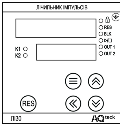
Рисунок 6.2 – Лицьова панель пристрою для корпусів настінного (Н) і щитового (Щ1) кріплення
