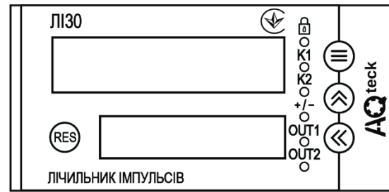
Рисунок 6.3 – Лицьова панель пристрою для корпусу щитового (Щ2) кріплення
