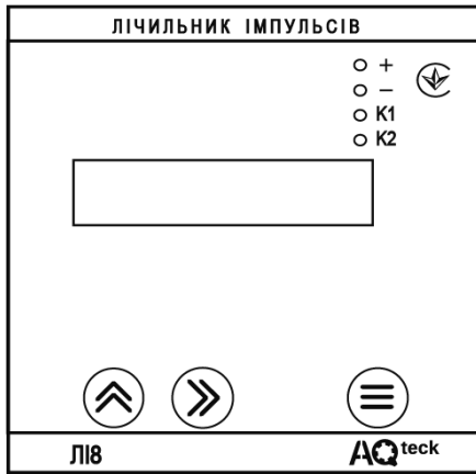
Рисунок 6.6 – Лицьова панель пристрою для корпусів настінного (Н) і щитового (Щ1) кріплення
