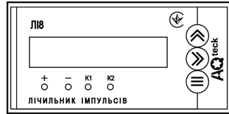
Рисунок 6.7 – Лицьова панель пристрою для корпусу щитового (Щ2) кріплення
