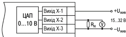
Рисунок 5.17 – Схема підключення навантаження до ВП типу У
