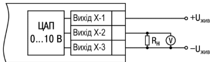
Рисунок 5.18 – Схема підключення навантаження до ВП типу У
