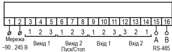
Рисунок 5.2 – Призначення контактів клемної колодки TPM212-Н, -Щ1 і -Щ2
