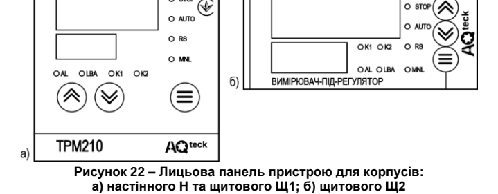
Рисунок 22 – Лицьова панель пристрою для корпусів: а) настінного Н та щитового ЦШ1; б) щитового ЦШ2
