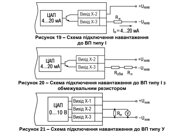
Рисунок 19 – Схема підключення навантаження до ВП типу І Рисунок 20 – Схема підключення навантаження до ВП типу І з обмежувальним резистором Рисунок 21 – Схема підключення навантаження до ВП типу У
