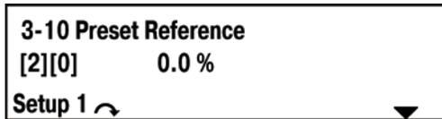
**Рисунок 4.1 – Отображение индекса элемента массива на ЖКИ**
