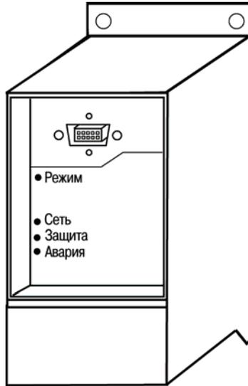
**Рисунок 3.2 – Лицевая панель прибора. Отсек подключения ЛПО**
