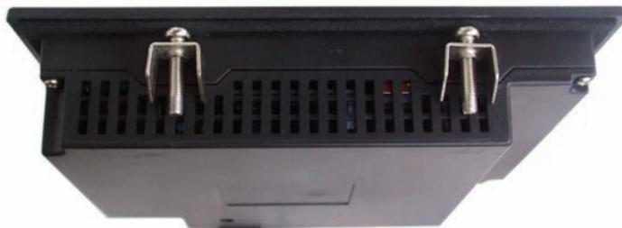
Рисунок 4.1 – Установка крепежных зажимов
