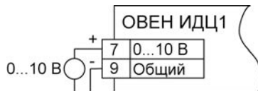
Рисунок 3.5 – Схема подключения к прибору датчиков с сигналами напряжения от 0 до 1 В, от 0 до 10 В
