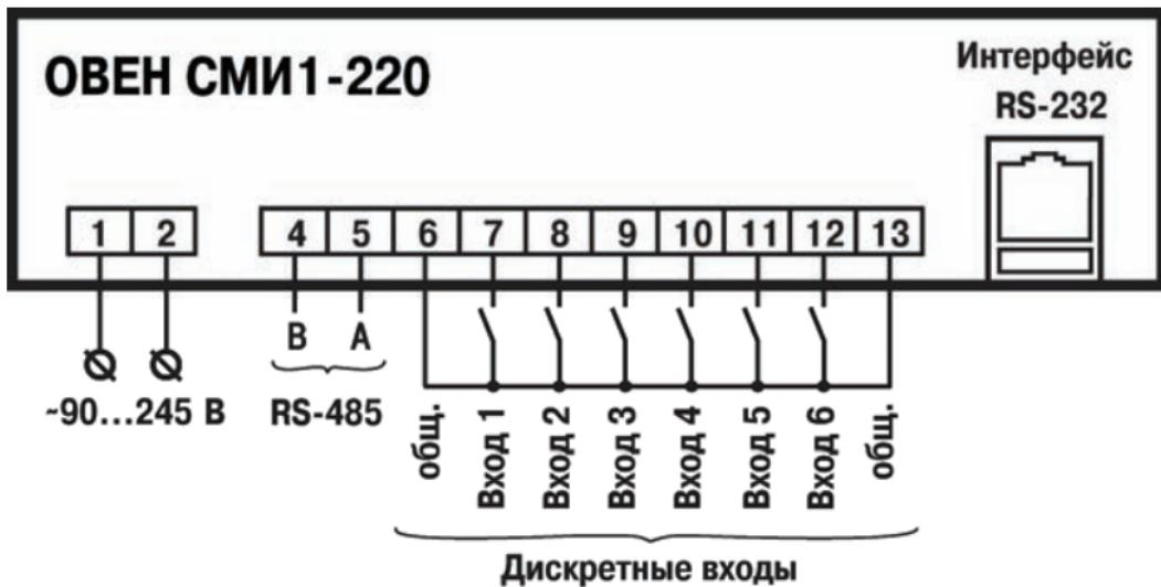
Рисунок Б.1 – Схема подключения ОВЕН СМИ1-220
