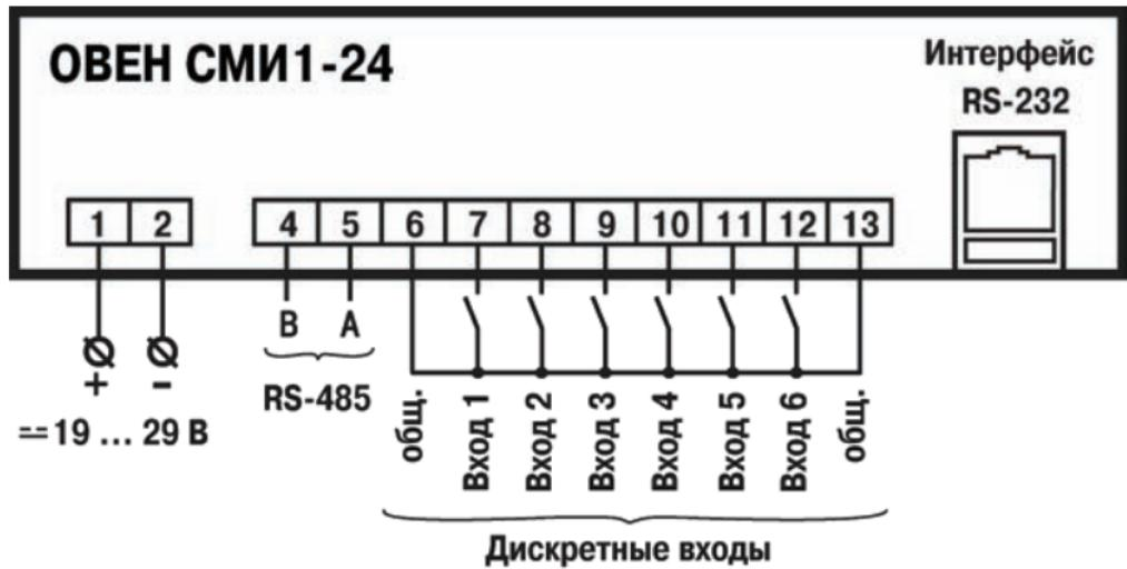
Рисунок Б.2 – Схема подключения ОВЕН СМИ1-24
