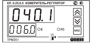
Лицевая панель прибора (корпус Щ2)
