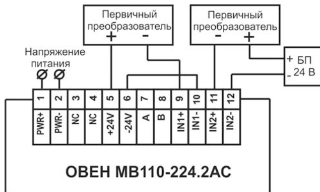
Рисунок Б.2 – Подключение к прибору двухпроводных первичных преобразователей
