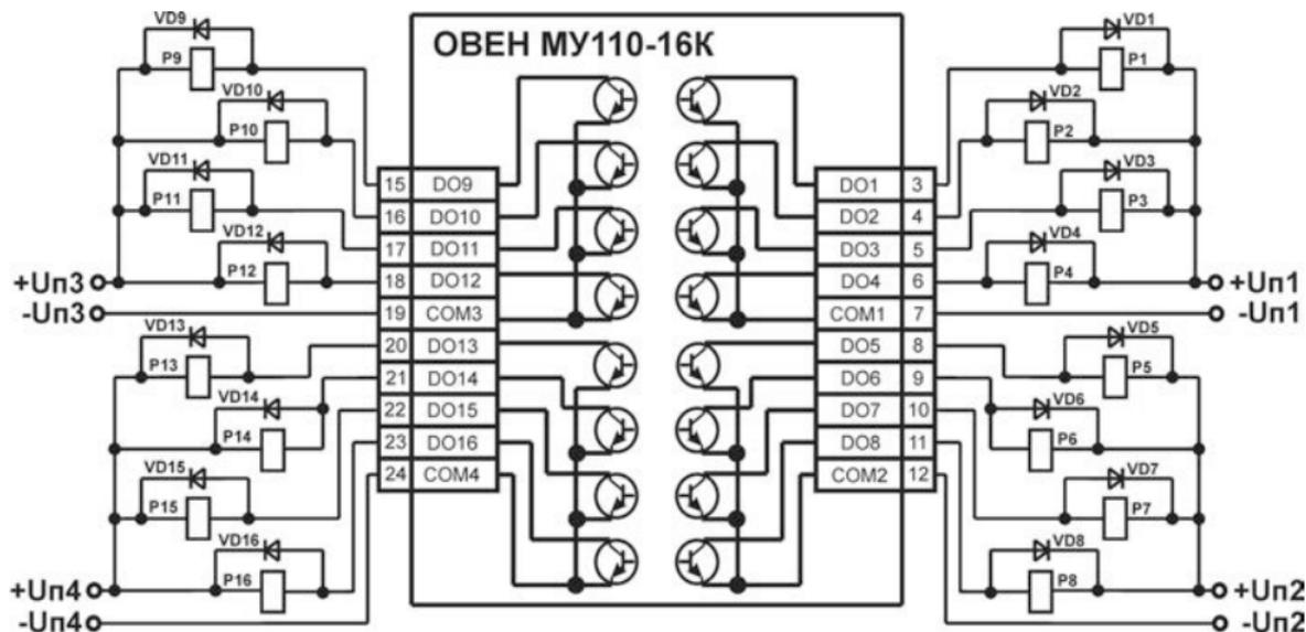
**Рисунок Б.3 – Схема подключения нагрузки к ВЭ типа К (для ОВЕН МУ110-16К)**
