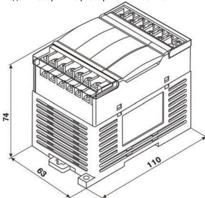
Рисунок А.1 – Габаритный чертеж ОВЕН МУ110
