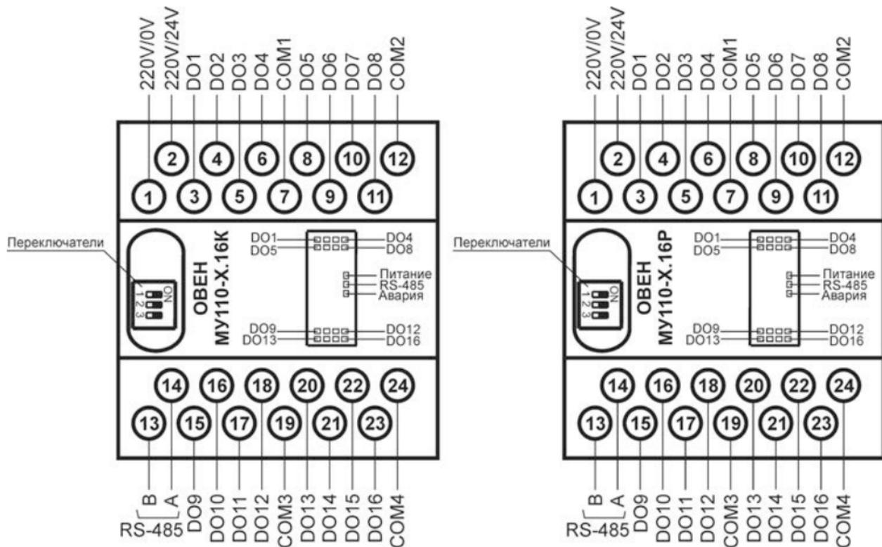
**Рисунок Б.1 – Общий чертеж ОВЕН МУ110-16Р и ОВЕН МУ110-16К**
