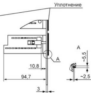
Рисунок А.7 - Прибор в корпусе Щ2, установленный в щит толщиной 3 мм
