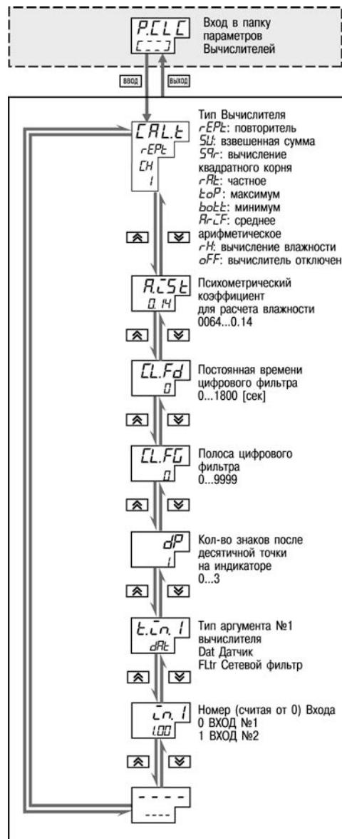
Рисунок 9.11 – Схема задания параметров Вычислителей
