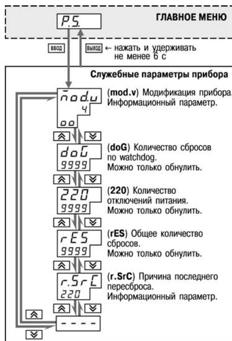
Рисунок 9.18– Схема доступа к служебным параметрам прибора
