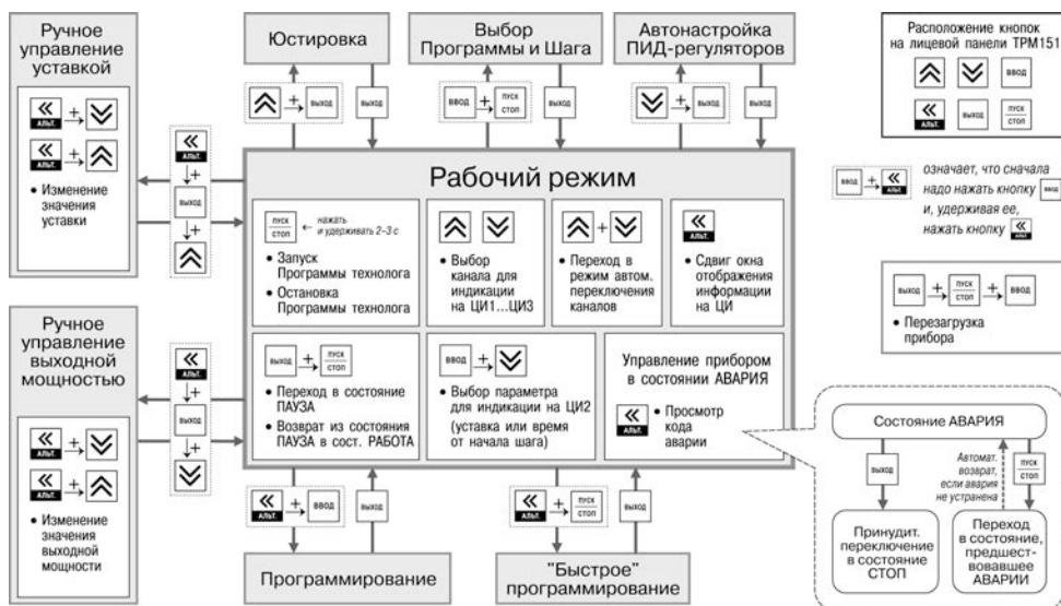
Рисунок 3.9 – Схема переключения режимов прибора
