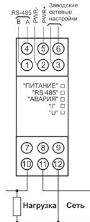
Рисунок Б.1 – Подключение прибора к однофазной сети
