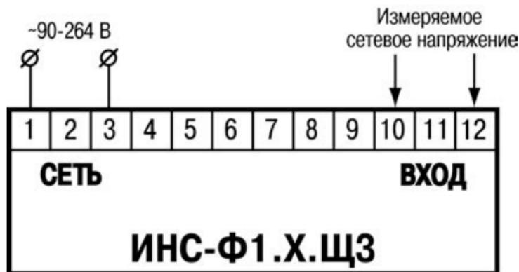
Рисунок Б.1 – Схема подключения прибора ОВЕН ИНС-Ф1.х.ЩЗ
