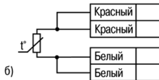
Рисунок В.2 – Схема подключения КДТС с коммутационной головкой: а) двухпроводная схема, б) четырехпроводная схема
