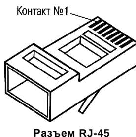
Рисунок В.4 – Разводка кабеля для соединения ПЛК с компьютером по сети Ethernet напрямую
