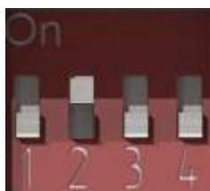
Рис. 6.12. DIP-переключатель. Джампер 2 в положении ON
