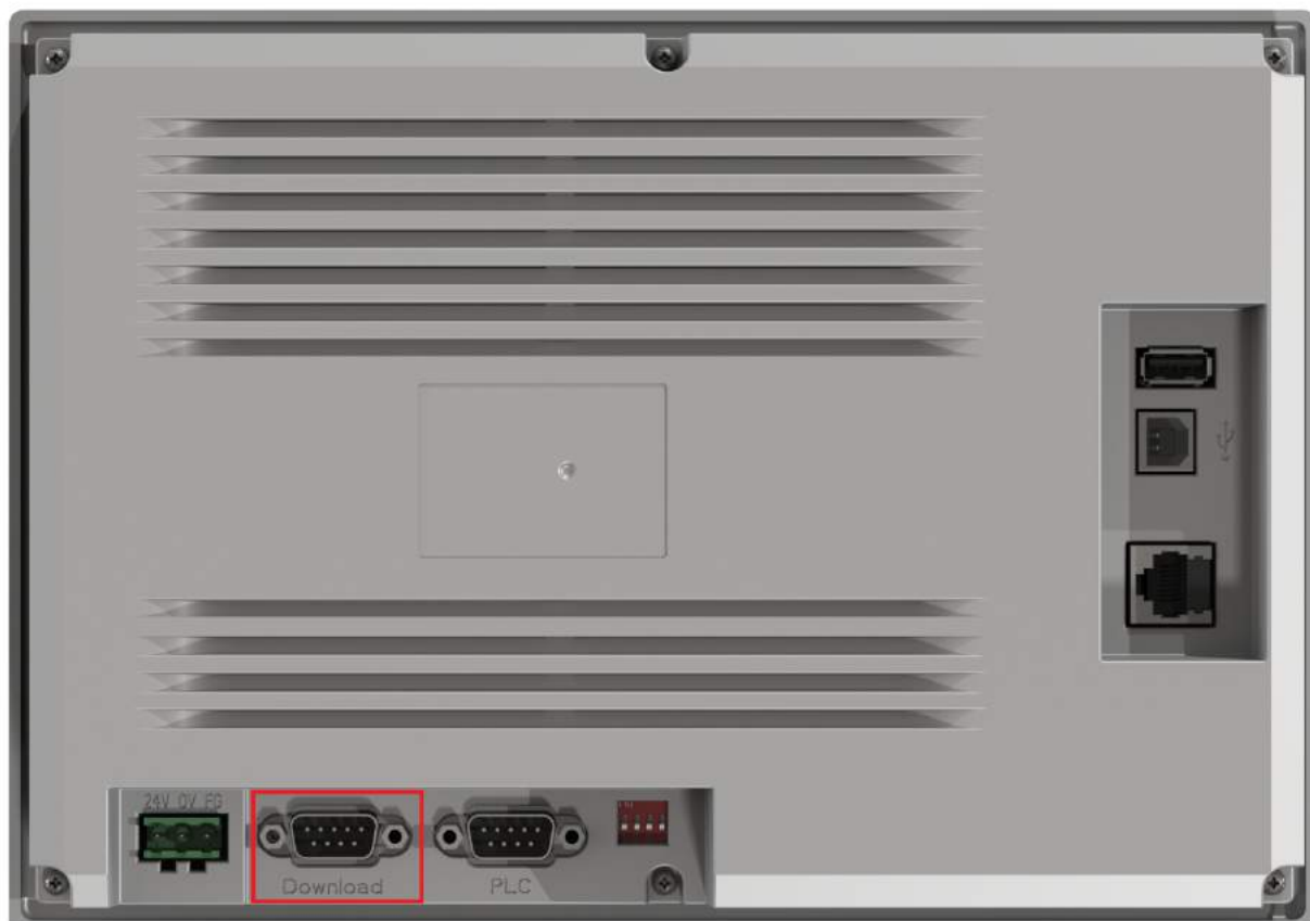
Рис. 6.7. Внешний вид задней крышки панели СПЗхх-Р ( Download-порт обведен красным)
