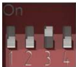
Рис. 9.59. DIP-переключатель. Джампер 3 в положении ON
