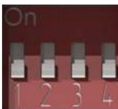
Рис. 6.13. DIP-переключатель. Джампер 2 в положении OFF
