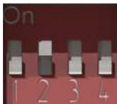
Рис. 6.4. DIP-переключатель. Джампер 2 в положении ON
