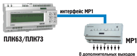
Расширение количества выходов путем подключения модуля MP1
