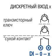
Схема подключения дискретных входов ПЛК100
