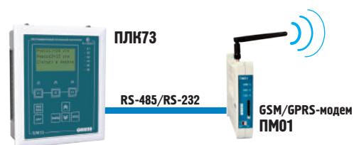
Подключение внешних устройств (например, GSM-модема)
