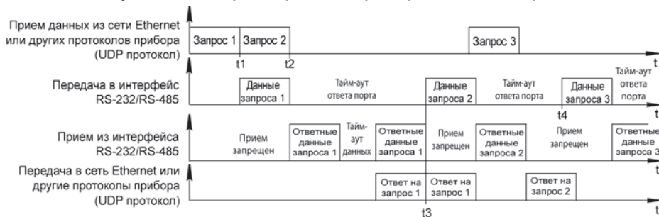
Рисунок 4.6 – Диаграмма работы прибора в режиме «запрос – ответ»
