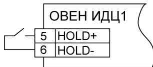
Рисунок 6.1 – Подключение коммутирующих устройств к контактам «HOLD»
