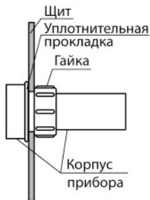
Рисунок 5.1 – Монтаж прибора в щит
