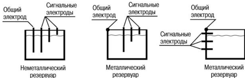
Рисунок 3.5 – Примеры установки кондуктометрических зондов
