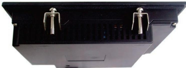
Рисунок 4.1 – Установка крепежных зажимов
