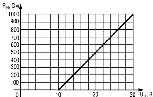
Рисунок 3.7 – График зависимости  $R_n$  ( $U_n$ )
