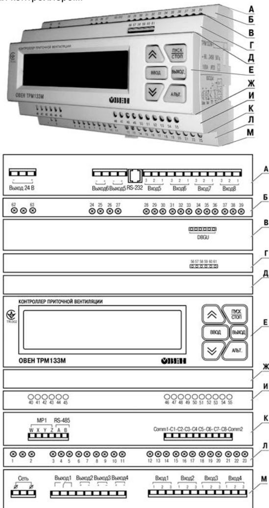
Рисунок 3.1 – Контроллер ОВЕН ТРМ133М-04: внешние связи, элементы индикации и управления
