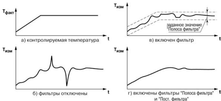
**Рисунок 3.3 – Временные диаграммы работы цифровых фильтров показаний датчика**
