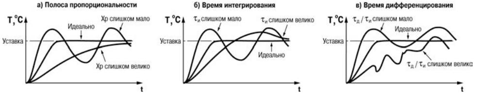
Рисунок Г.3 – Примеры графиков переходной функции
