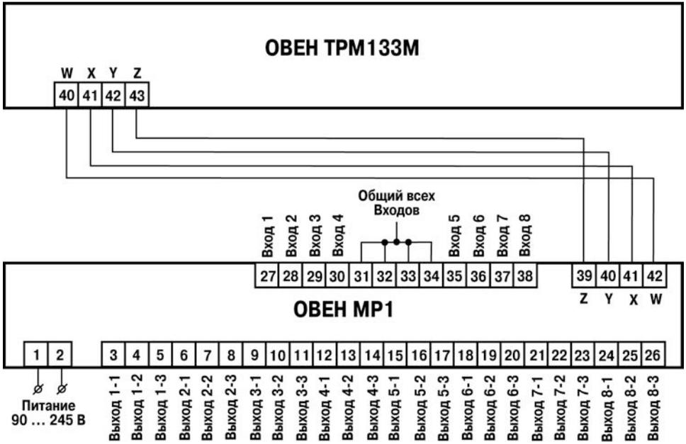
Рисунок Б.1 – Схема подключения ОВЕН TPM133M-04 и модуля ОВЕН MP1
