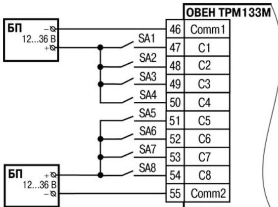
Рисунок Б.2 – Подключение датчиков к дискретным входам
