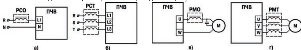
Рисунок 5.1 – Схемы подключения реакторов: а) серии РС0 во входных цепях питания ПЧВ с однофазным входом; б) серии РСТ во входных цепях питания ПЧВ с трехфазным входом; в) серии РМО в выходных цепях ПЧВ для питания однофазных электродвигателей; г) серии РМТ в выходных цепях ПЧВ для питания трехфазных электродвигателей
