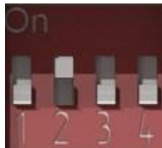
Рис. 6.12. DIP-переключатель. Джампер 2 в положении ON
