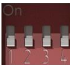
Рис. 6.6. DIP-переключатель. Джампер 2 в положении OFF
