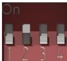
Рис. 6.4. DIP-переключатель. Джампер 2 в положении ON
