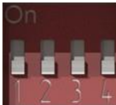
Рис. 6.13. DIP-переключатель. Джампер 2 в положении OFF
