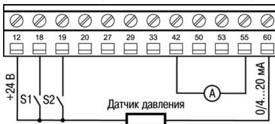
Рисунок 4.10 – Схема подключений конфигурации поддержания давления
