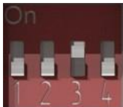
Рис. 9.64. DIP-переключатель. Джампер 3 в положении ON
