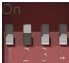
Рис. 6.12. DIP-переключатель. Джампер 2 в положении ON
