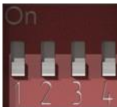
Рис. 6.13. DIP-переключатель. Джампер 2 в положении OFF
