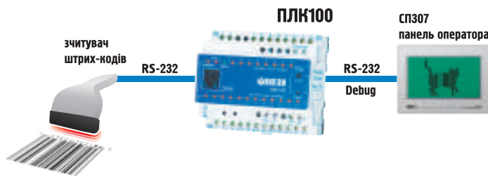
Підмикання зовнішніх пристроїв з нестандартними протоколами (наприклад, зчитувача штрих-кодів)
