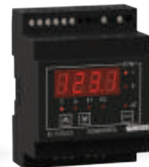
Д на DIN-рейку 72×90×58 мм IP20
