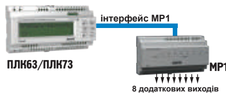
Розширення кількості виходів шляхом підмикання модуля MP1
