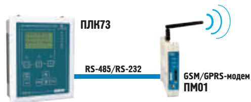
Підмикання зовнішніх пристроїв (наприклад, GSM-модему) в режимі CSD/SMS
