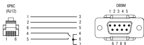
Схема кабелю КС3 «ПЛК-Модем»
